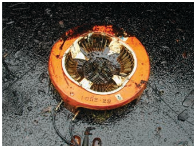
▲ Figura 15: skimmer de discos trabajando correctamente en un derrame reciente de petróleo crudo ligero. Sin embargo, si los hidrocarburos emulsionaran considerablemente, la eficacia de la operación de recolección se reduciría debido a la incapacidad de la emulsión de adherirse a los discos.
