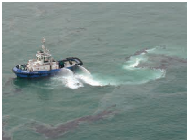
▲ Figura 14: la elevada viscosidad de los hidrocarburos ha provocado una aplicación insatisfactoria del dispersante, que se indica por el típico penacho blanco del dispersante alrededor de los hidrocarburos.
