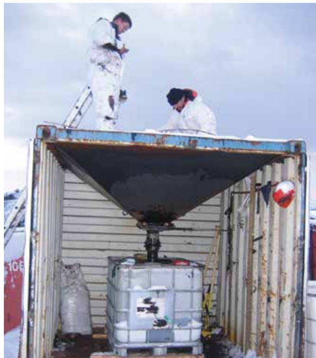
▲ Figura 16: sistema improvisado de filtración de residuos en el que los hidrocarburos recolectados pasan a través de un embudo con rejilla para filtrar residuos.
