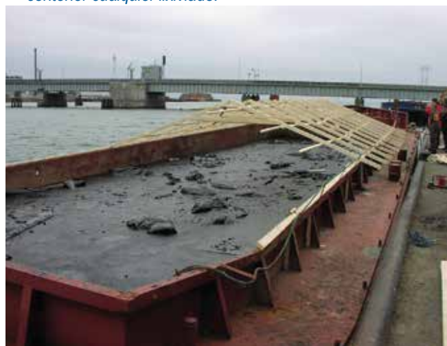
▲ Figura 10: almacenamiento de hidrocarburos recolectados en una barcaza. Se requiere una cubierta para evitar la entrada de agua.
