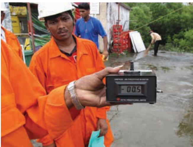
▲ Рис. 14: Демонстрация портативного газоанализатора фосфина за пределами опасной зоны.
