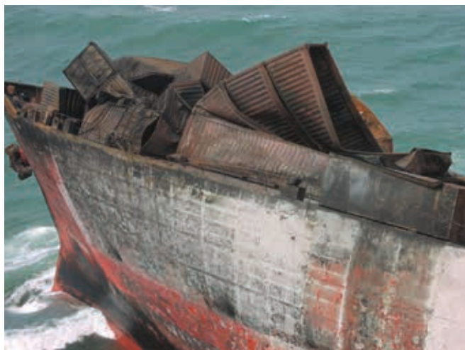
▲ Рис. 9: Контейнеры, деформированные в результате пожара в носовой части севшего на мель трейлера.
